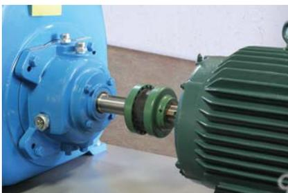
Acoplamento sem espaçamento Sure-Flex Plus® da TB Wood's, tamanho 6, instalado em uma unidade autoescorvante de bomba Summit/GPM. Este motor de baixa rotação/torque elevado exigiria, normalmente, um acoplamento de tamanho 7.
