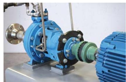
Um acoplamento Sure-Flex Plus® de tamanho 7 da TB Wood’s foi possível de ser instalado, em vez de um acoplamento maior de tamanho 8 em uma pequena unidade de bomba Summit/GPM ANSI Group 1. Ao utilizar o acoplamento menor, o tamanho geral do conjunto foi reduzido, permitindo menor área ocupada da placa de base.
